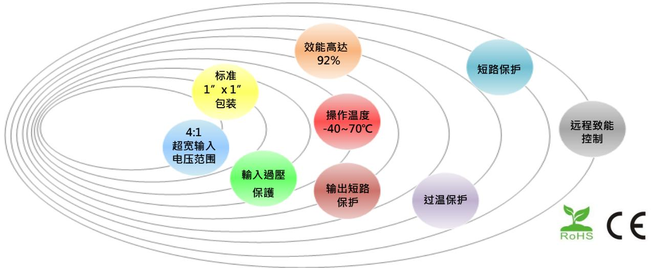
**EA2 Series** 是功率达 **30~40 Watt** · 效能高达 **92%** · 标准双排 1" x 1" 包装的隔离型-稳压式-电源转换器 · 可接受 9~36VDC & 18~75 VDC 的超宽输入电压范围 · 输出提供 5V, 12V, 15V, ±5V, ±12V, and ±15V, 具有输出短路保护/输出过电流保护、过温度保护、输出过电压保护 · 另有二个选项功能---远程致能控制以及输出电压调节。
